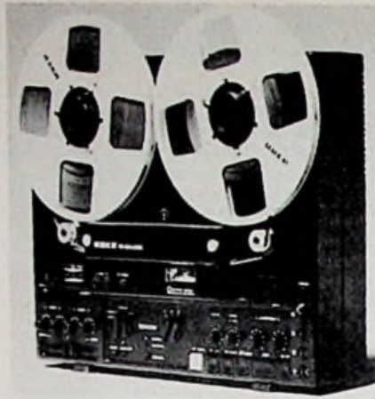
Afb. 5. Recorder zonder aandrukrol (Uher).
