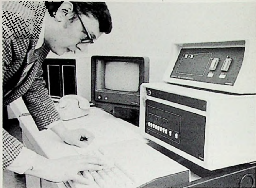
De Siemens programmeerplaats voor microcomputers omvat o.a. een PROM-programmeerapparaat (rechts boven), een floppy-disk-systeem (links) en een video display, waarvan het toetsenbord de eigenlijke invoermogelijkheid voor de gebruiker vormt. Met deze installatie kan de gebruiker zijn software in eigen bedrijf, eventueel in time sharing met een grote computer, zelf vervaardigen resp. aanpassen.
