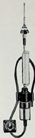
Afb. 9. Gecombineerde elektronica- en motorantenne van Poddig. Het elektronische deel — de antenneversterker — zit boven en de elektromotor voor het in- en uitschuiven van de telescoop onder.
